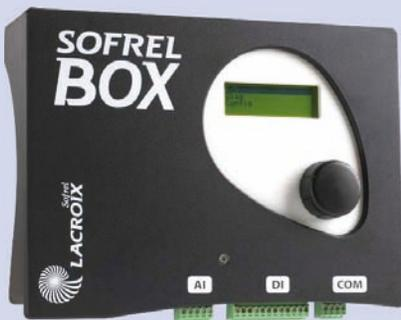
Ils autorisent notamment l'acquisition d'informations de contrôle (niveaux, compteurs, ...) et la communication inter-sites vers un poste local de télégestion Sofrel S500. Alimentés par pile (technologie Lithium) et équipés d'une électronique très faible consommation, ils offrent une autonomie de plusieurs années. En fin de vie, l'utilisateur pourra remplacer simplement la pile sans avoir à déposer le produit.
