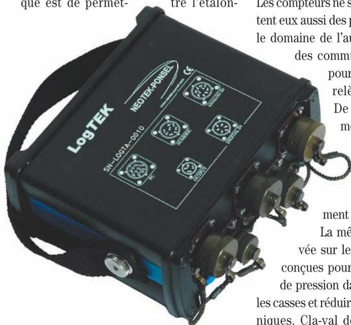
Chez Neotek, le Logtek est doté d'une capacité de mémoire de 65.000 données par voie avec des intervalles d'enregistrement configurable de 1 seconde à 24 heures.
