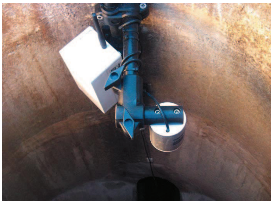
Figure 3 : Capteur avec son montage de fixation articulé, et son électronique associée.
